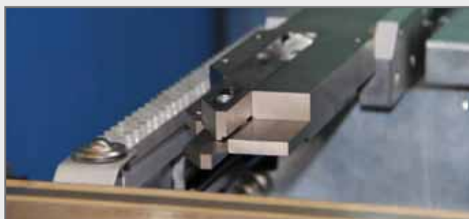
Supporto pneumatico in posizione di sostegno della lamiera Pneumatic support ready the sheet metal bending
